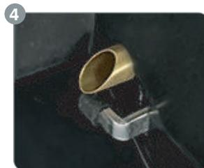
Am Schneidemesser und an der Innenseite der Injektionsöffnung haft auch Tabak und sollte ebenfalls gereinigt werden.
