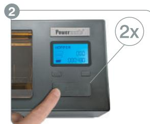
Espere a que aparezca HOPPER. Pulse START y esperar a que el inyector salga del todo. Cuando la inyector haya salido del todo, pulse START de nuevo.
