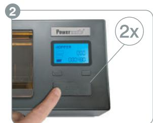
Warten Sie, bis HOPPER erscheint. Drücken Sie START und warten Sie, bis der Füllstab herauskommt. Wenn der Füllstab ganz heraus ist, drücken Sie erneut START.
