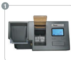
Open het deksel van het tabaksreservoir en verwijder alle resten uit het reservoir en de laadkamer. Sluit het deksel en druk op START.
